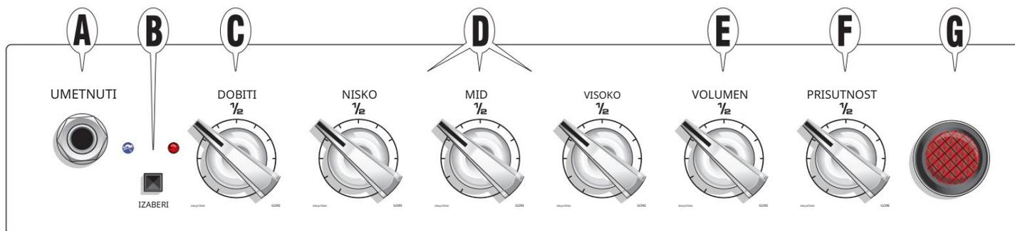
A. UMETAK: Ovdje uključite gitaru koristeći samo visokokvalitetni oklopljeni kabel za instrumente.
